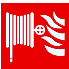
Agulheta de incêndio
